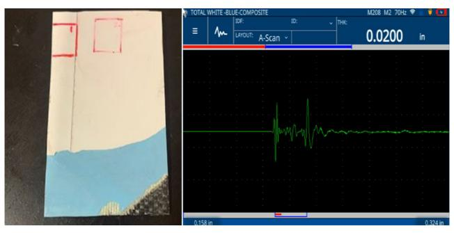
单个涂层厚度:在该测量中,20 Mhz探头和超声波设置经过优化,将复合材料上三个涂层中每一层的回声进行放大。该涂层包括一个表面处理层和两层面漆。
